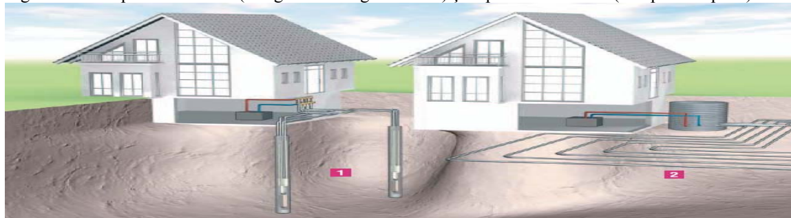
Figura nr.16 Captarea verticală (stânga-1-sonde geotermice) și captarea orizontală (dreapta-2-captori)
