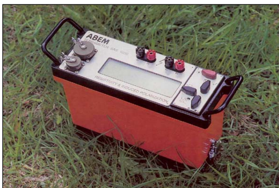
Dispozitivul cvadripolar AMNB utilizat.
